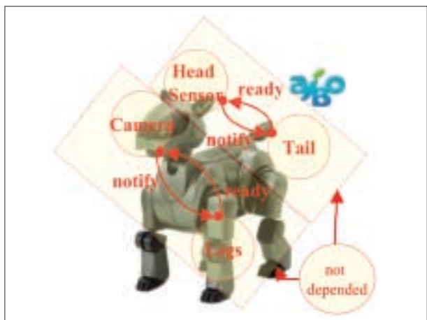
AIBO ソフトウェアモデルの分割検証 Compositional Verification of AIBO-Robot Control Software
