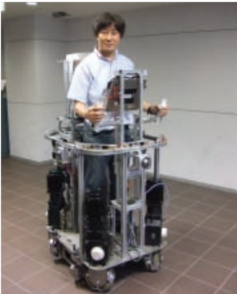
全方向に移動できる個人用知的移動体のプロトタイプ Personal Intelligent Vehicle Capable of Omni-Directional Movement
