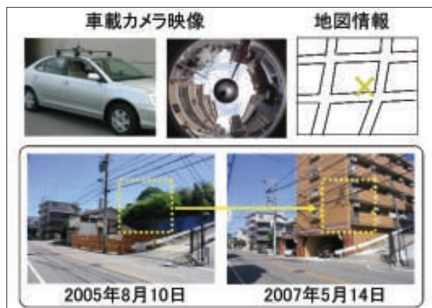
車載カメラ映像による建物変化の自動検出 Automatic Detection of Urban Scenery Change using Car-mounted Cameras
